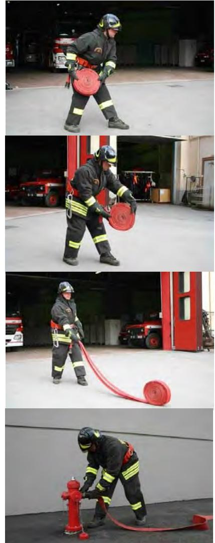
Nell'uso si dovrà evitare (utilizzando eventuali materiali o attrezzature di protezione) l'appoggio delle manichette su spigoli appuntiti o taglienti, o su superfici eccessivamente scabrose, per evitare che subiscano tagli, abrasioni, forature, etc
